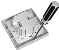
Рисунок 5. Демонтаж лицевой панели
